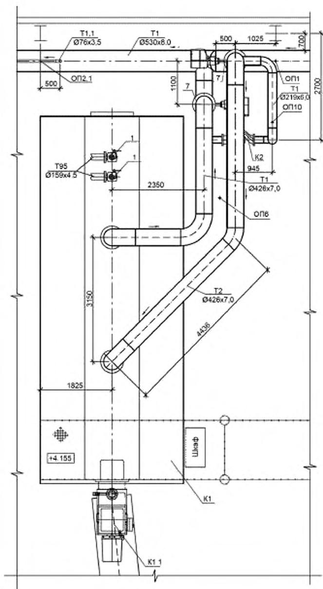
Рисунок В.1 — Пример выполнения плана расположения трубопроводов
