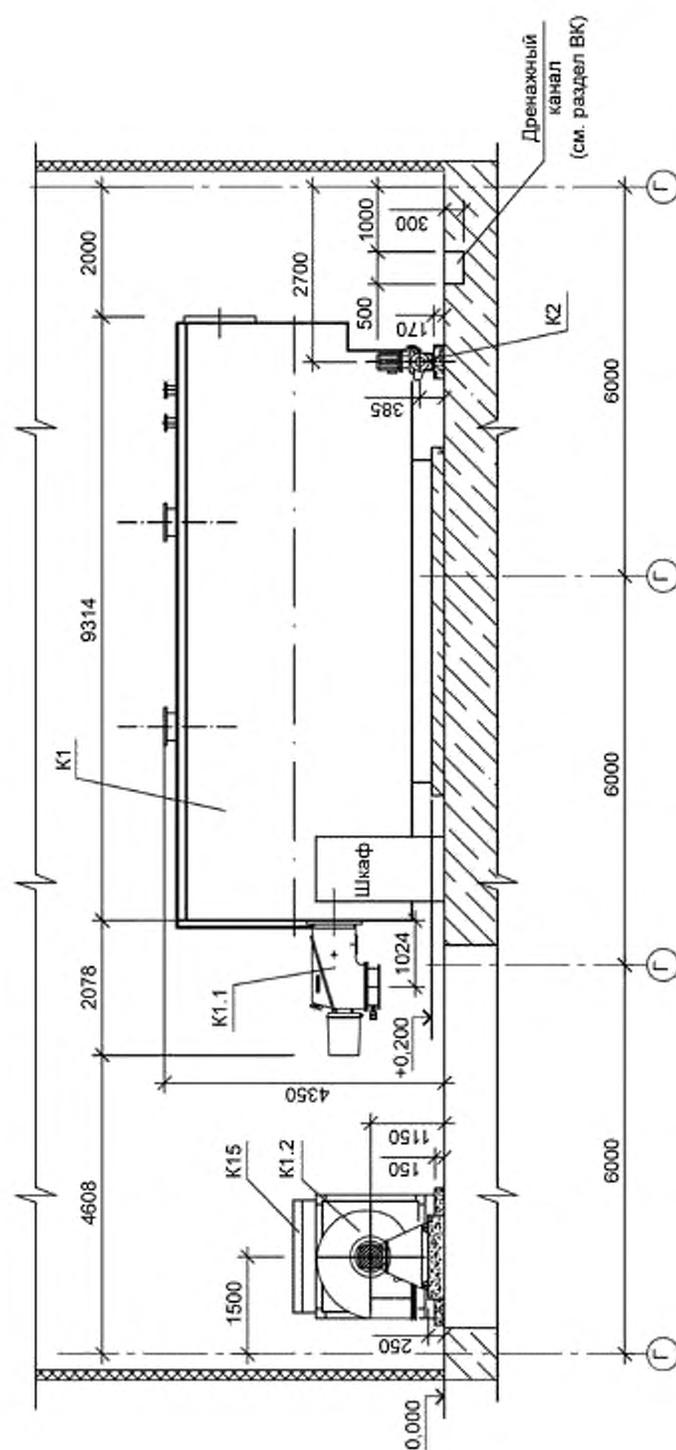
Рисунок А.2 — Пример выполнения разреза расположения оборудования
