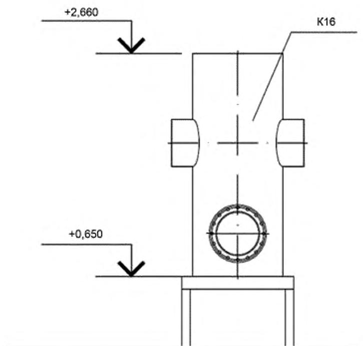
Рисунок Г.6 — Пример выполнения разреза установки грязевиков
