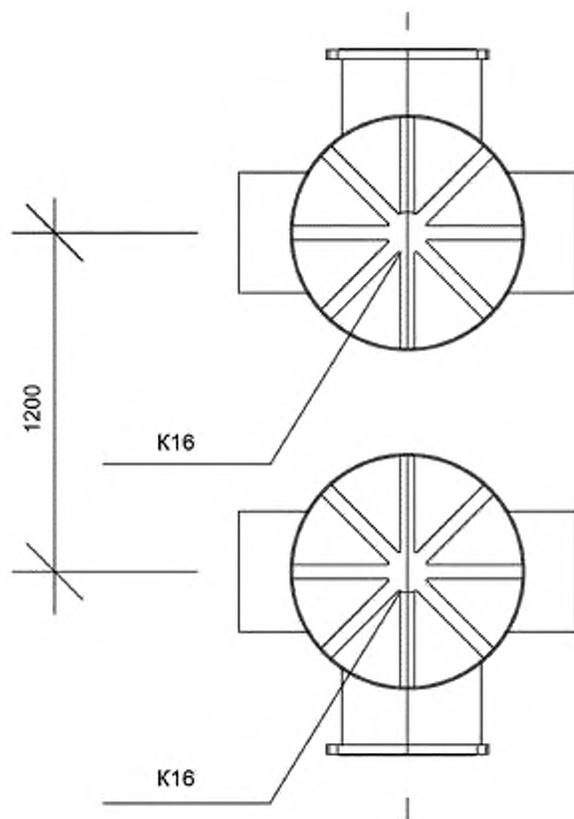
Рисунок Г.5 — Пример схемы установки грязевиков
