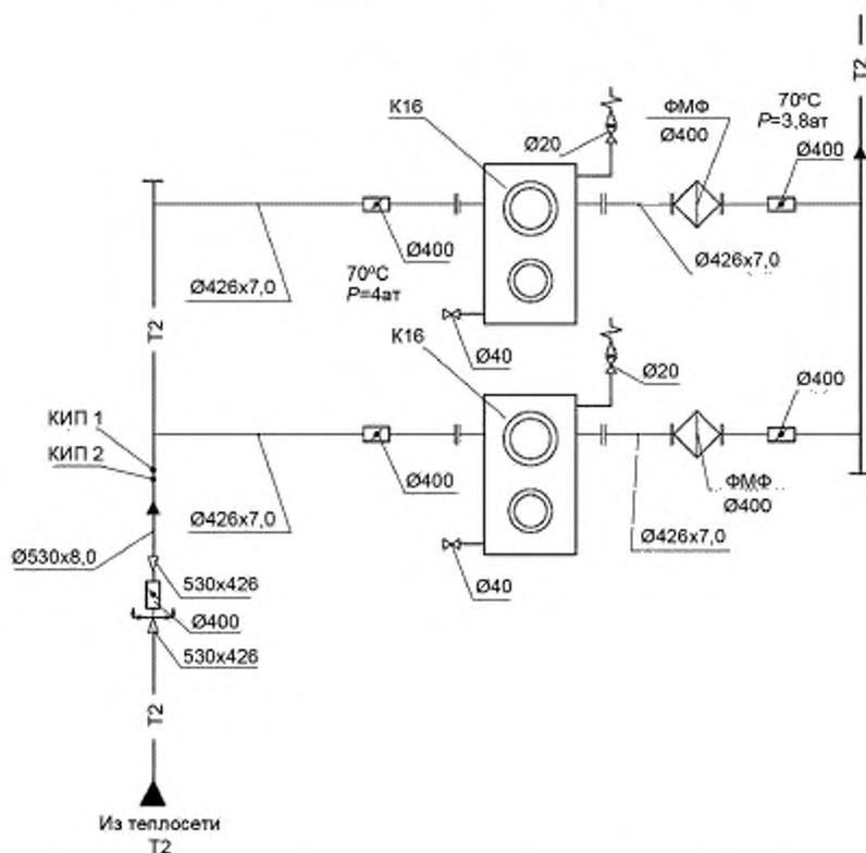
Рисунок Г.4 — Пример выполнения схемы установки грязевиков
