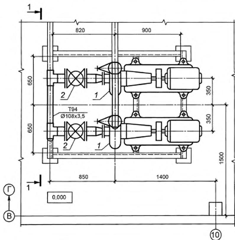
Рисунок Г.2 — Пример выполнения плана установки
