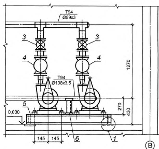
Рисунок Г.3 — Пример выполнения разреза установки насосов
